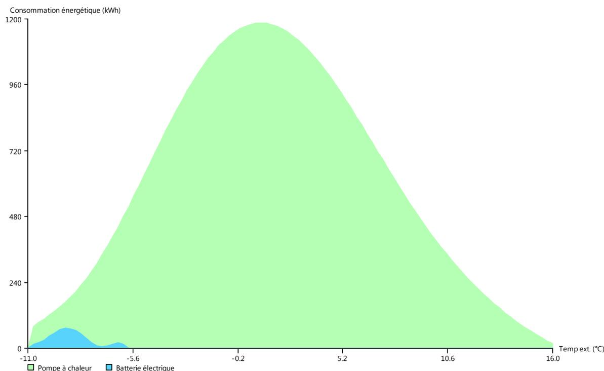
Puissance thermique (kWh) est donnée à des intervalles de 1 °C
